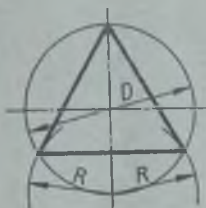
Разделить окружность на 3 и 6 равных частей
