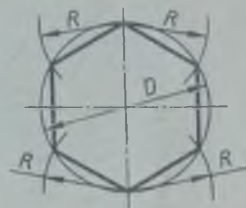
Разделить окружность на 3 и 6 равных частей
